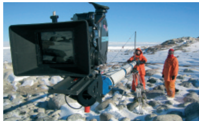
Mechanisches «Tele»: Dieses Gestell ermöglicht grossräumige Panorama-Schwenker mit der Kamera.
