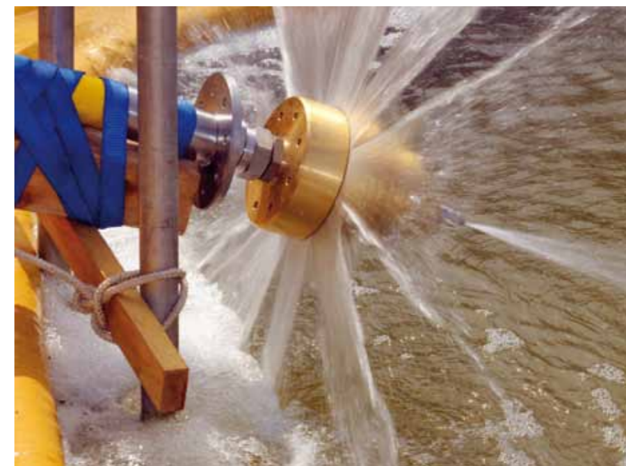
Das «englische System»: Eine Sonde verspritzt Heisswasser und schmilzt sich so durchs Eis – hier bei einem Test in England.
